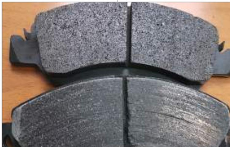
► **1.** Comprobar el espesor durante la inspección del vehículo y reparar las anomalías de las pastillas. Una pastilla nueva tiene un grosor de unos 15 mm, cuando el espesor disminuye a los 2-3 mm, es necesario sustituir la pastilla. Las pastillas de las ruedas delanteras se desgastan más rápido que las traseras.
