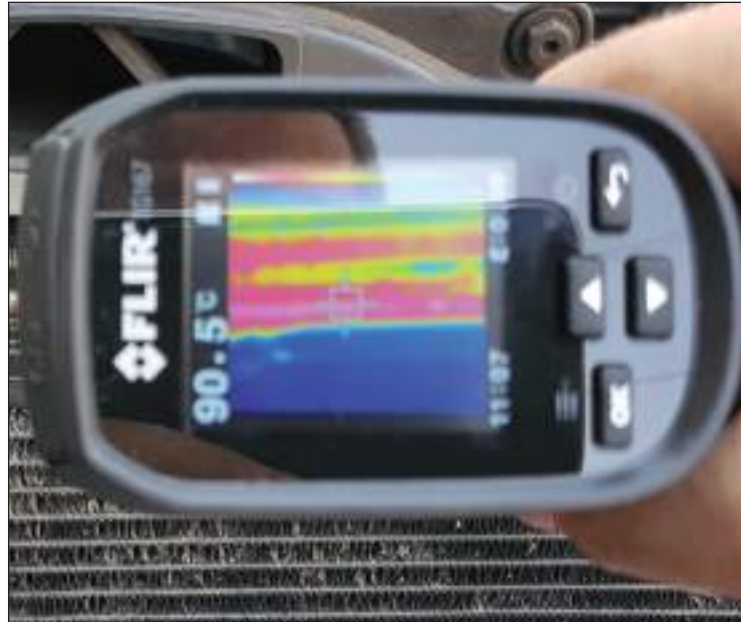
Radiador ensamblado mecánicamente. Tubos redondos, sin conexión fija entre tubos y aletas. Menor rendimiento de enfriamiento.
